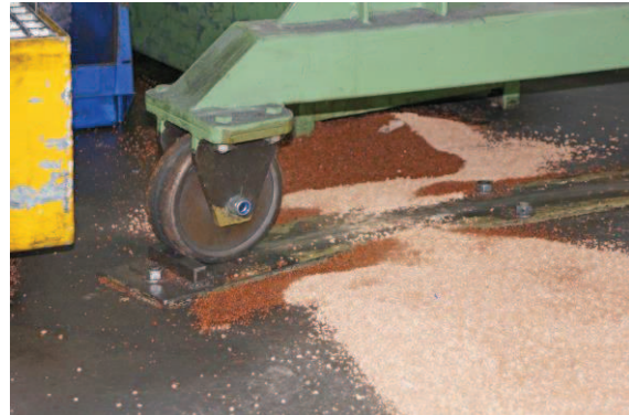
Granulate verschmutzen den Hallenboden und können dauerhaft eingesetzt auch Maschinen beschädigen
