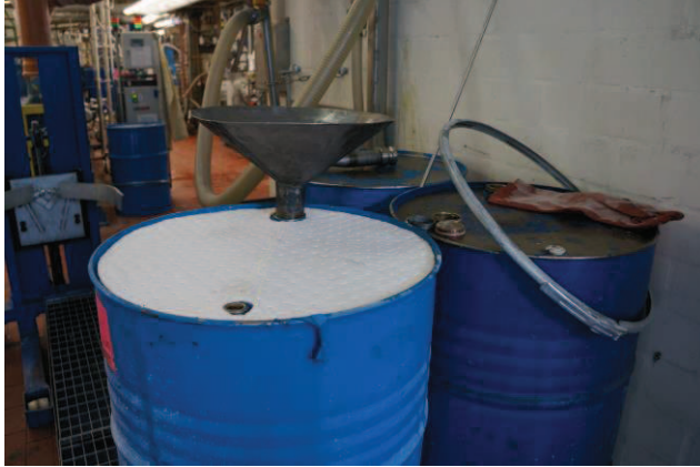
Fassabdeckung aus Polypropylen-Vlies, extrem einfach und sicher in der Handhabung
